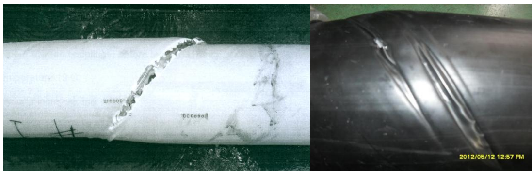
如上图：“突然开裂破坏”与“灯笼形破坏”（上海邦中公司实验照片）
