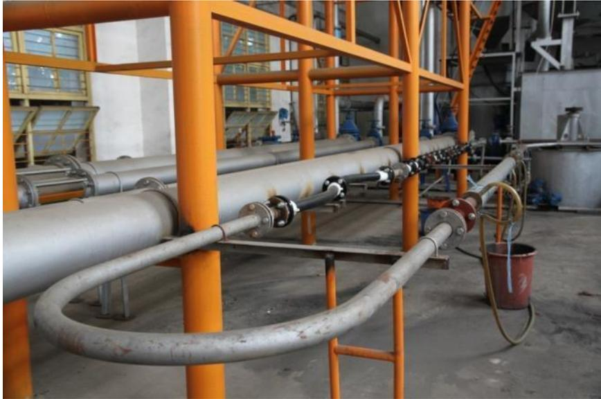
图 10 浆体环管磨蚀试验现场照片
